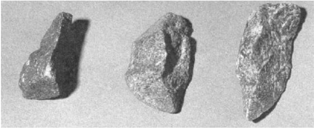
Figura 227 - 2. Partículas fracturadas (bordes agudos, superficies rugosas)
