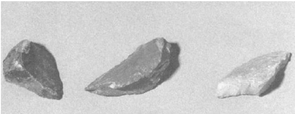
Figura 227 - 3. Partículas fracturadas (bordes agudos, superficies lisas)
