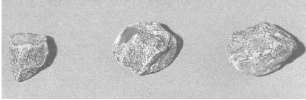
Figura 227 - 4. Partículas fracturadas (bordes redondeados, superficies rugosas)
