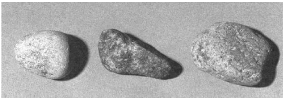
Figura 227 - 7. Partículas no fracturadas (partículas redondeadas, superficies lisas)
